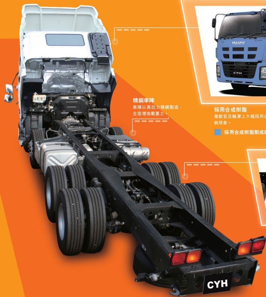
鋁合金製造油缸及風缸 有效防止生鏽，確保持久耐用。
