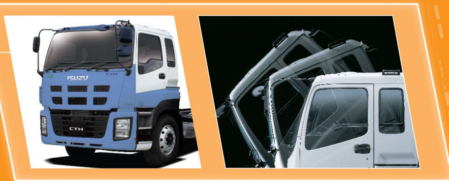
採用合成樹脂 駕駛室及輪罩上大幅採用合成樹脂，有效防止腐蝕現象。
