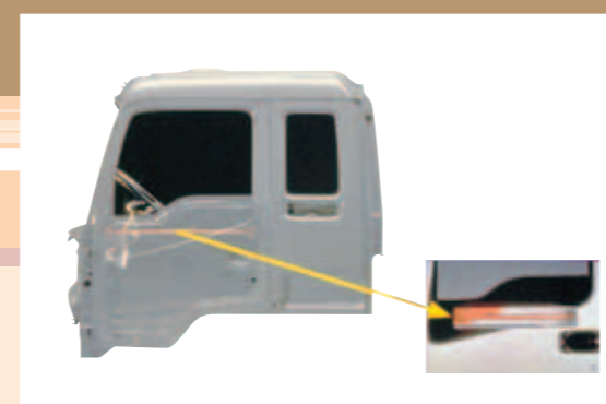
車門防撞桿 車門內置防撞桿，能減輕從側面而來的撞擊，把對駕駛者及乘客造成的傷害降至最低。
