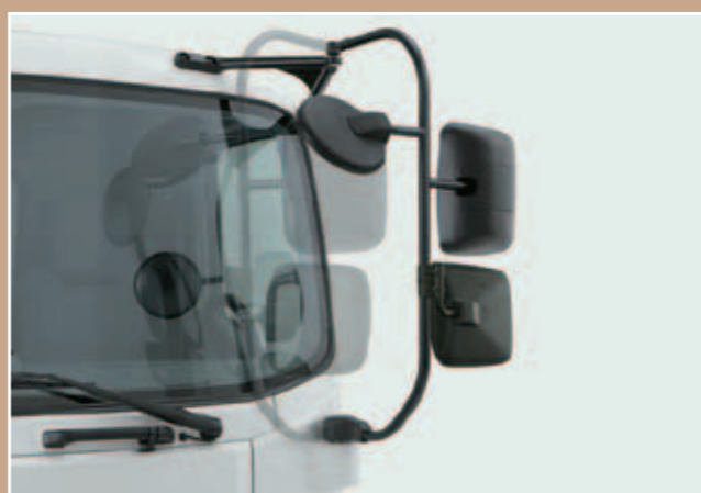
電動倒後鏡 左邊電動摺疊特大倒後鏡，方便日常操作。
