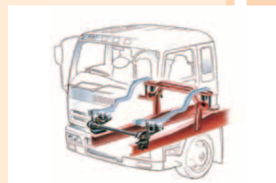
車門防撞桿 車門內置防撞桿，能減輕從側面而來的撞擊，把對駕駛者及乘客造成的傷害降至最低。
