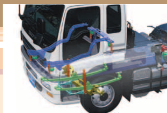
先進懸掛系統 採用龍船葉片式彈簧懸掛系統，令行車更平穩。
