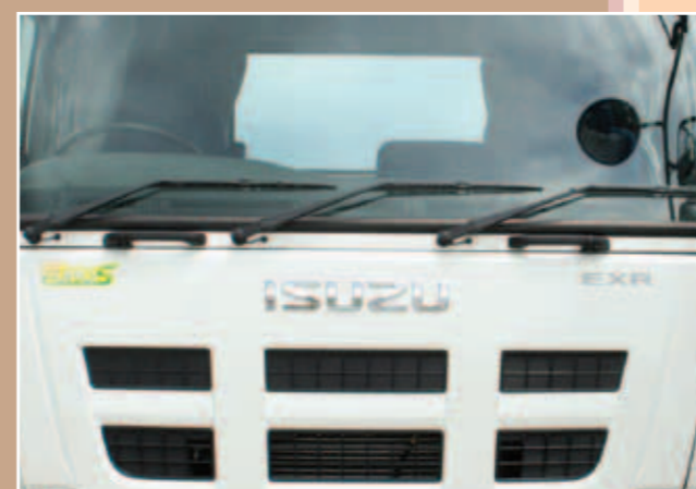
三噴咀式水撥 三噴咀式水撥設計，無懼任何惡劣天氣，提供清晰視野，而且更換簡易。
