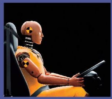
3點式安全帶 於撞擊瞬間發揮效用，將駕駛者拉靠座位，減低衝擊力。
