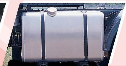
油缸以鋁合金製造，有效防止生鏽，確保持久耐用。
