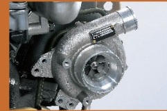
VGS可變角度渦輪增壓系統 (Variable Geometric System)
