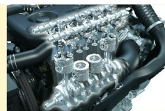
OHC頂凸輪軸，16氣門 (Over Head Cam)
