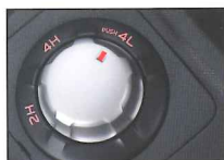
電子按鈕(飛躍式)行駛 同步四驅轉換器 (只適用於TFS87型號)
