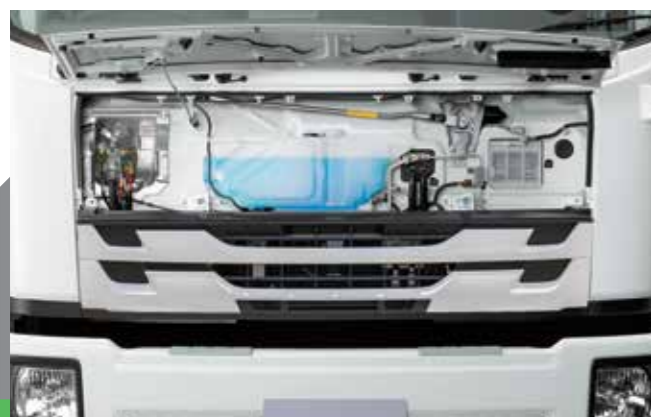
前置檢查裝置，日常檢查簡單便利。
