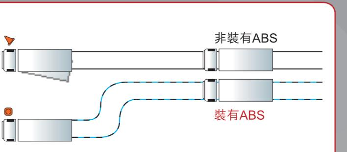
全新五十鈴NHR87/NMR85車系引入多項先進安全裝置，包括ABS防鎖制動系統，可精確控制每個車輪的制動力，提供更穩定安全的制動表現。加上一系列安全配備，全面提升安全度，為駕駛者提供最周全的保障。
