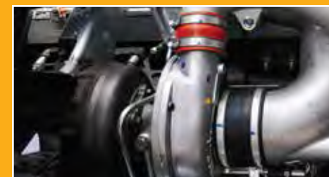
VGS可變角度渦輪增壓系統 (Variable Geometric System)
