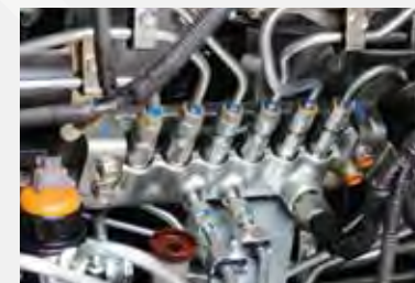
CRS電子控制高壓共軌噴注系統 (Common Rail System)
