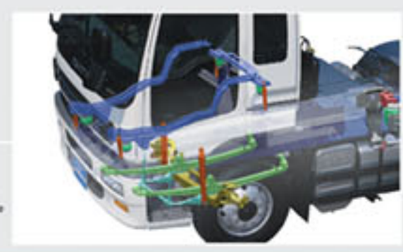
先進懸掛系統 採用龍船葉片式彈簧懸掛系統，令行車更平穩。
