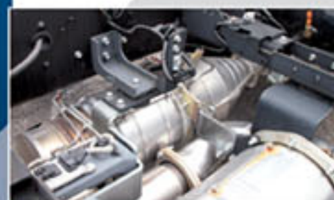
DPD柴油微粒過濾器和SCR選擇性催化還原系統 (Selective Catalytic Reduction)
