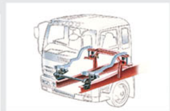
避震駕駛室 氣墊式避震駕駛室，進一步降低駕駛者所受震盪，即使行駛顛簸路面亦穩定舒適。
