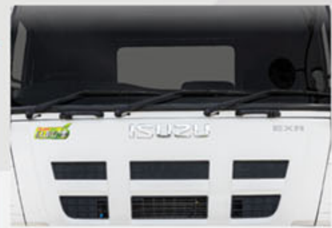
三噴咀式水撥 三噴咀式水撥設計，無懼任何惡劣天氣，提供清晰視野，而且更換簡易。
