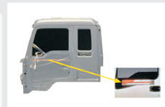
車門防撞桿 車門內置防撞桿，能減輕從側面而來的撞擊，把對駕駛者及乘客造成的傷害降至最低。
