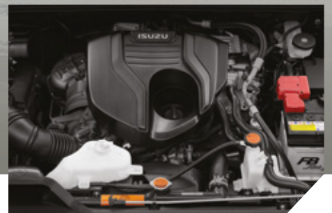
全新歐盟環保6d型 ISUZU RZ4EE6S VGS Turbo引擎，最高馬力達163匹，扭力高達36.7 公斤/米
